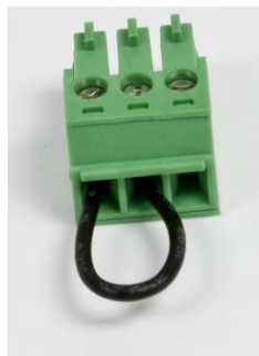
Figura 5-6: Cable de puente entre los terminales de transmisión y recepción COM1
