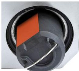
Insérez une batterie complètement chargée dans le logement à cet effet avec l'extracteur filaire pointant vers l'extérieur du terminal. Alignez le méplat de la batterie avec celui du logement, conformément aux indications de gauche.
