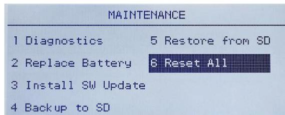
**Figure 3-32 : Réinitialisation de tous les blocs de configuration**
