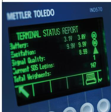
Das IND570 bietet integrierte Mechanismen für einen Selbsttest zusammen mit proaktiven Alarmfunktionen, die das Personal bei Systemproblemen benachrichtigen. Leistungsdaten, Diagnoseprotokolle und Systemicherungen unterstützen die Serviceteams von METTLER TOLEDO bei ihren Bemühungen, Ihre Prozesse wieder online zu bringen und für Sie arbeiten zu lassen.
