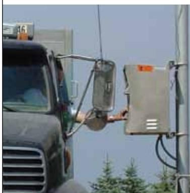
Автоматизируйте водительские терминалы, чтобы сократить операционные затраты. С помощью таких устройств водители самостоятельно, без операторов, регистрируют в системе результаты взвешивания. Способы регистрации и порядок сбора данных определяет владелец системы.
