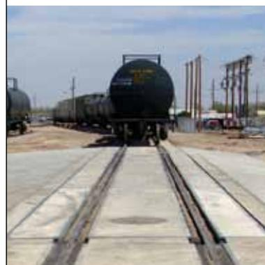
Можно сэкономить средства, и пространство, установив систему, способную взвешивать и вагоны, и грузовики. На одной весовой платформе можно взвешивать и стоящие вагоны, и автомобили. Для удобства и безопасности передвижения грузовых автомобилей рельсы утоплены в платформу.
