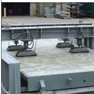
МЕТТЛЕР ТОЛЕДО — единственный производитель, который проводит тестирование реальных весовых модулей на долговечность. На испытательном стенде Module Masher модули подвергаются полной расчетной нагрузке, соответствующей 20 годам взвешивания груженого автотранспорта. Такая проверка подтверждает способность автомобильных весов выдерживать реальные нагрузки.
