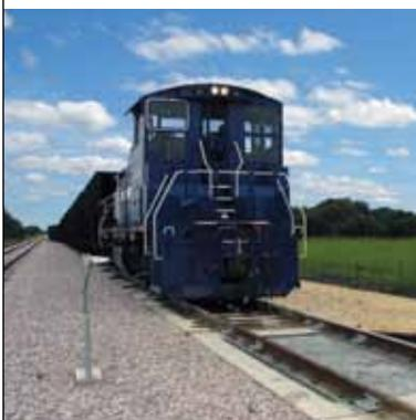
Весы для взвешивания в движении (СИМ-системы) используются для взвешивания сцепленных между собой железнодорожных вагонов, которые движутся по весам со скоростью от 5 до 8 км/ч (3–5 миль/ч). Такая система позволяет ускорить процедуру взвешивания и повысить ее безопасность, так как не нужно отцеплять вагоны по отдельности и перемещать их на весы для статического взвешивания.
