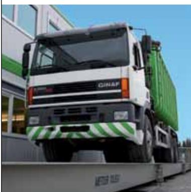
Les bascules pleine longueur conviennent idéalement au pesage réglementé. Grâce à leur conception modulaire, les ponts-bascules peuvent même prendre en charge les camions les plus longs et les opérations de chargement les plus complexes. Le résultat est un pesage fiable, même en cas de trafic important en environnement exigeant.
