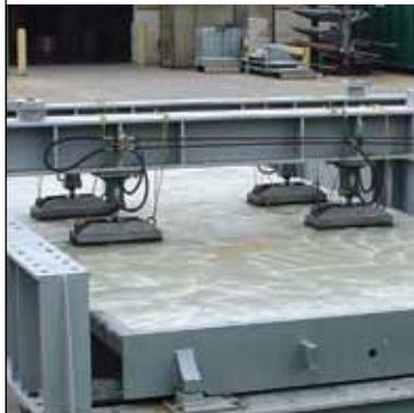
METTLER TOLEDO es el único fabricante que realiza pruebas de todo el ciclo de vida en módulos de básculas reales. El soporte de prueba Module Masher simula 20 años de pesaje de camiones con su nivel máximo de carga. Este procedimiento de prueba sirve para verificar que la báscula de camiones es capaz de soportar los requisitos de pesaje de vehículos del mundo real.
