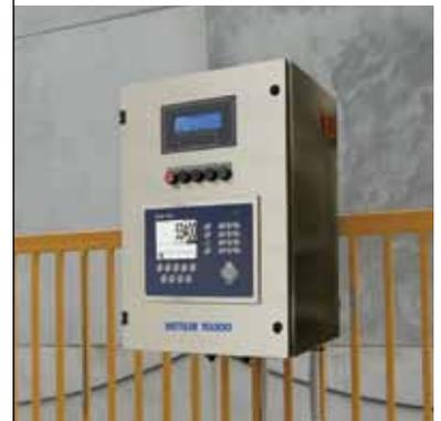
Simplifique el pesaje en movimiento con un controlador que capta automáticamente el ID del vagón y la información sobre su peso mientras el tren pasa sobre la báscula. El controlador registra e imprime la información del peso, mientras almacena los datos de cientos de trenes.
