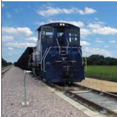
Una báscula para vía férrea en movimiento con vagones acoplados (CIM, del inglés coupled in-motion) se usa para pesar vagones unidos que recorren la báscula a una velocidad de 5-8 km por hora. Acelera la operación de pesaje y hace que sea más segura al eliminar la necesidad de separar cada vagón y colocarlo sobre una báscula estática.
