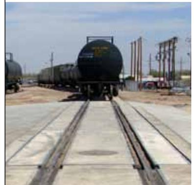
Ahorre dinero y espacio con una báscula que combine el pesaje de vagones y camiones. Una única plataforma de pesaje combina una báscula estática para vía férrea con una plataforma de pesaje de camiones. Las vías se disponen de modo que formen una superficie plana sobre la que los camiones puedan pasar con facilidad y seguridad.
