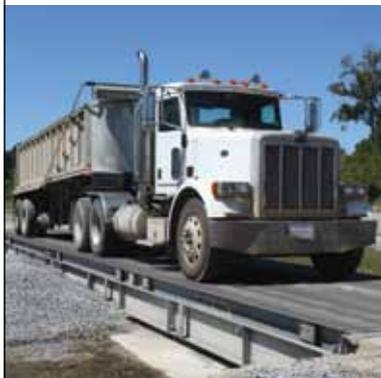
Las básculas portátiles son ideales para operaciones de pesaje que requieren movilidad. Las estructuras de acero permiten reubicar rápidamente y con facilidad las básculas, lo que evita el tiempo y el coste de hacer una nueva base de hormigón. En lugar de esperar semanas para que endurezca el hormigón, se puede instalar y usar una báscula portátil en solo unas horas.
