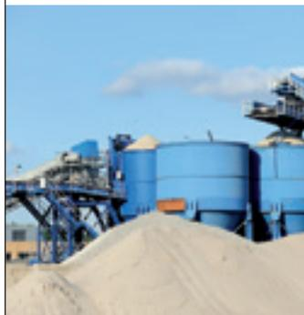
La technologie de pesage employée pour le dosage du béton et de l'asphalte doit pouvoir résister à la poussière, l'humidité, les vibrations, la chaleur et les variations de température et produire des données de pesage fiables sur toute la durée de vie de l'équipement.
