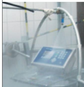
METTLER TOLEDO exploite plusieurs laboratoires d'essais certifiés ISO/IEC 17025 : 2005, chargés de réaliser des essais selon les normes internationales EN/IEC. Ils sont capables de simuler le chargement statique et dynamique, ainsi que tous types d'effets environnementaux, tels que l'impact des chocs, des vibrations, de la température, de l'eau et des poussières.
