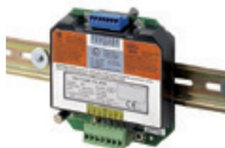
Etablit la connexion entre un capteur de pesage situé en zone dangereuse et un terminal installé hors zone dangereuse. L'ISB limite l'énergie transmise en zone dangereuse afin de protéger des risques d'inflammation en atmosphère potentiellement explosive.
