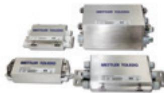
Ces boîtes de jonction conviennent aux branchements simples et rapides de plusieurs capteurs de pesage sur des dispositifs électroniques de pesage. Les interrupteurs rotatifs intégrés permettent de réduire au minimum les erreurs d'angle en n'utilisant simplement qu'un tournevis ; aucune soudure ni aucune résistance séparée ne sont nécessaires
