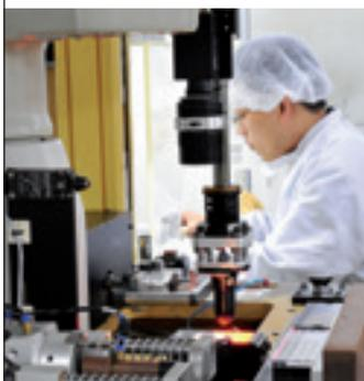
Les jauges dynamométriques sont fixées au châssis métallique par un robot, à l'intérieur d'une chambre blanche. Toutes les usines METTLER TOLEDO sont équipées de technologies de production avancées et mettent en oeuvre les méthodes actuelles de gestion de production. Ces usines sont certifiées ISO 9000 et ISO 14000.
