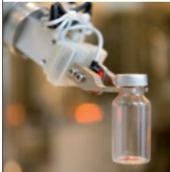
Le dosage automatique rapide et précis des médicaments, la préparation médicamenteuse, la manipulation des produits toxiques ou des matières dangereuses en milieu stérile et confiné hermétiquement nécessitent des modules de pesage équipés de boîtiers en acier inoxydable et de dispositifs de nettoyage intégré.
