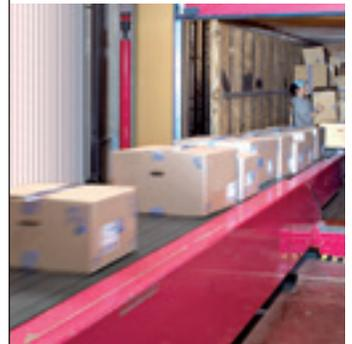
Les modules de pesage spécialement conçus pour les convoyeurs d'entrepôts et les centres logistiques aéroportuaires, absorbent la force des chocs latéraux dus aux déplacements des colis, des palettes et des conteneurs. Les terminaux disposant d'un logiciel dédié au traitement du pesage dynamique se chargent de corriger les résultats de pesage.
