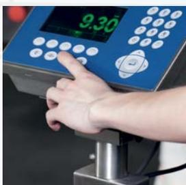
Proaktive Warnmeldungen informieren den Benutzer über die Waagennutzung und zeigen potenzielle Probleme an, bevor diese kritisch werden. Mit Audit Trails lassen sich Stoss- und Überlasten sowie extreme Temperaturabweichungen für jede Waagezelle und das gesamte System verfolgen. So kann der Benutzer mögliche Fehlermuster erkennen und gezielt Verbesserungen vornehmen.
