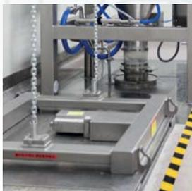
Analoge Waagezellen sind überaus anfällig für Fehler durch elektromagnetische Störungen, die meist von anderen Drahtlosgeräten ausgehen. Die intelligente Elektronik der digitalen Waagezelle sorgt für mehr Genauigkeit, indem automatisch die Umgebungsbedingungen kompensiert und mögliche Störungen beseitigt werden.
