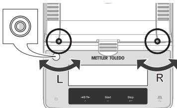
يجب إعادة تسوية الجهاز في كل مرة يتم فيها تغيير مكانه. لتحديد الاتجاهات الأفقية بدقة، يحتوي الجهاز على مؤشر استواء (مستوى) واثنين من مسامير التسوية. عندما تكون فقاعة الهواء عند مؤشر الاستواء في المركز بالضبط، يكون الجهاز متسوياً تماماً. لتسوية الجهاز، تابع ما يلي:
