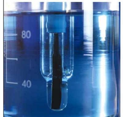
Lorsqu'une électrode InLab ISM (Intelligent Sensor Management) est connectée, l'instrument le détecte automatiquement et enregistre son ID, son numéro de série et les dernières données d'étalonnage. La durée de configuration de l'instrument est réduite ainsi que le risque d'erreur (grâce à la détection de l'électrode).
