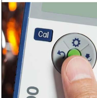
Les boutons mécaniques disposés en T des instruments Seven2Go optimisent la navigation dans les menus et les paramètres de mesure. La navigation intuitive et rapide permet de réduire le temps entre chaque mesure.
